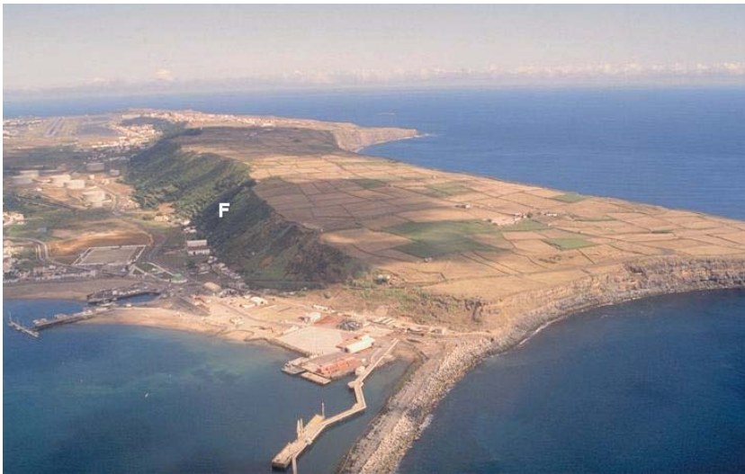
Foto 6. Escarpa de falha de Santiago (F), na Praia da Vitória, que define o bordo NE do Graben das Lajes. Nessa zona, a falha apresenta uma separação vertical média de 70 m, com o bloco SW (à esquerda) abatido.
